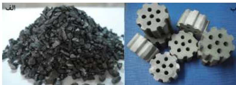
شکل ۱-۴ الف) کاتالیست بدون پایه سنتز آمونیاک؛ ب) کاتالیست پایه‌دار احیای مستقیم آهن.
